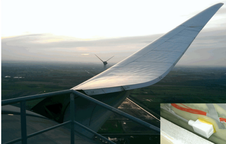
Abb.1: Rotorblatt einer Windkraftanlage mit faseroptischem Sensor
